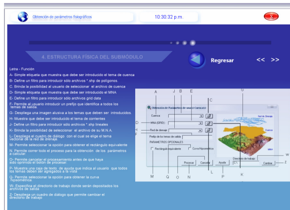
Figura 77. Estructura del control D de la interfaz de ayuda del módulo de obtención de parámetros fisiográficos.
