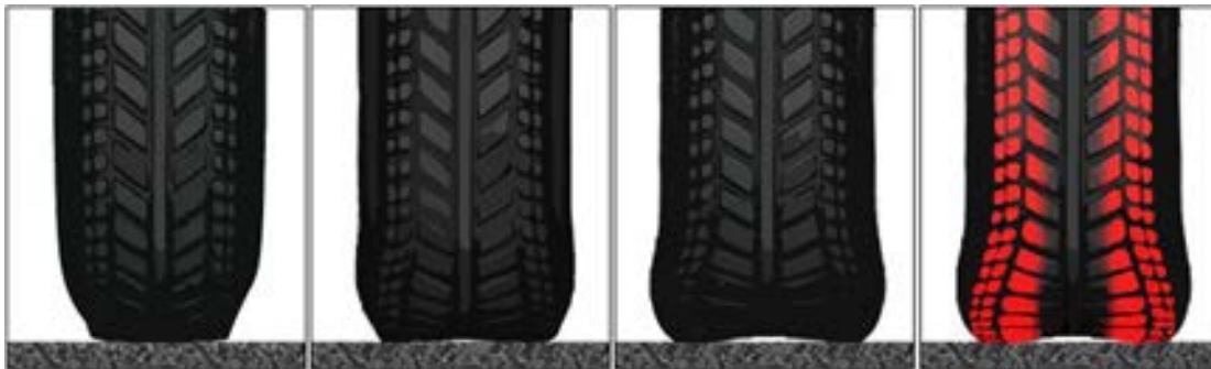
Figura 3.5 Imagen de la huella de pisada con una baja presión.
