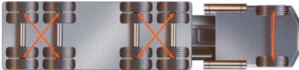
Figura 3.6 Rotación de Neumáticos.
