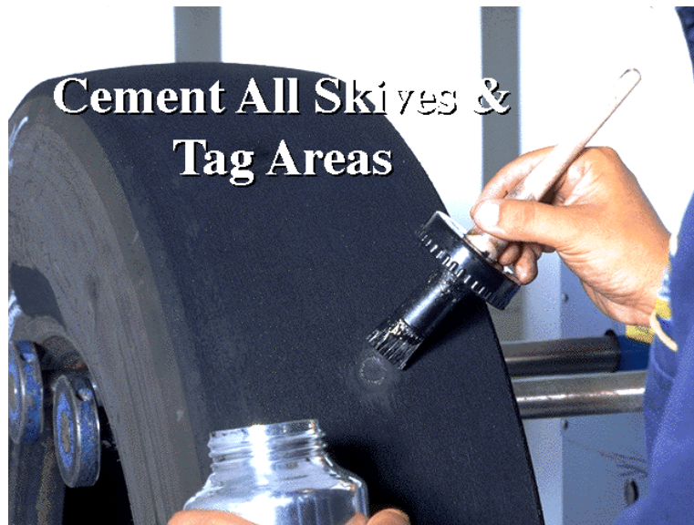
Figura 2.11 Cementado en la base y sub base del neumático.
