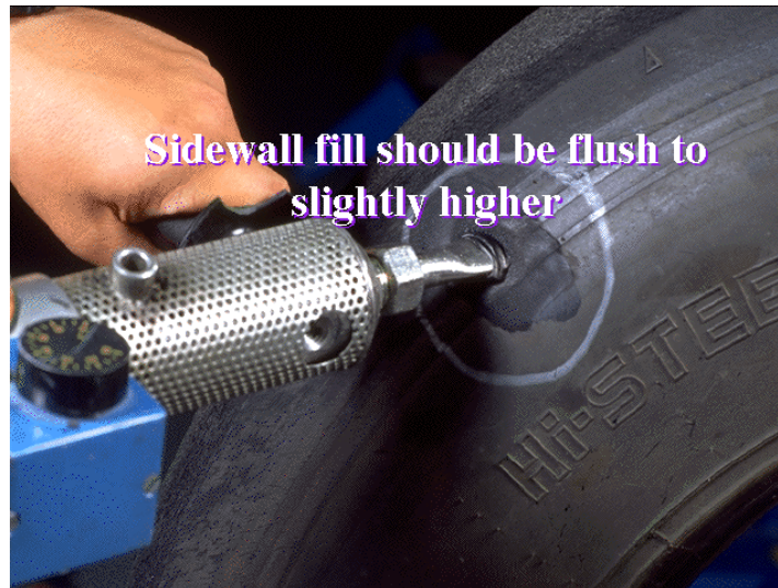
Figura 2.13 Relleno con cordón extrusor.
