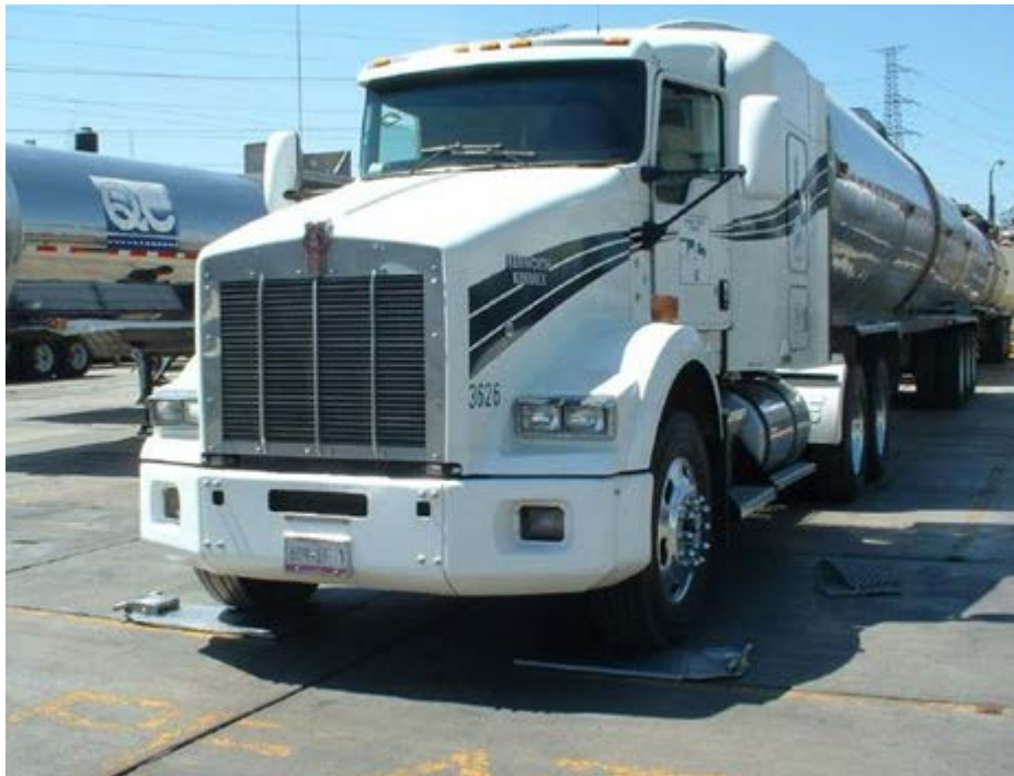
Figura 3.1 Pesaje de Pipa doble semirremolque.
