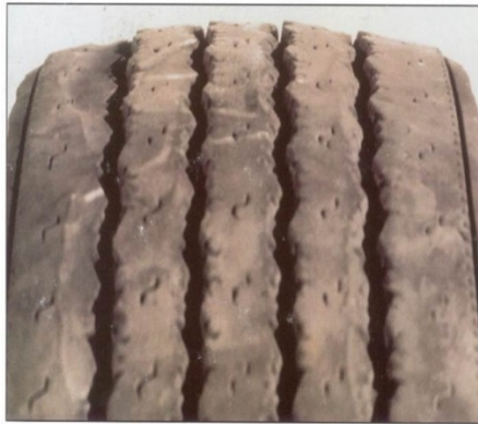
Figura 5.39 Imagen Desgaste tipo contrapelo.
