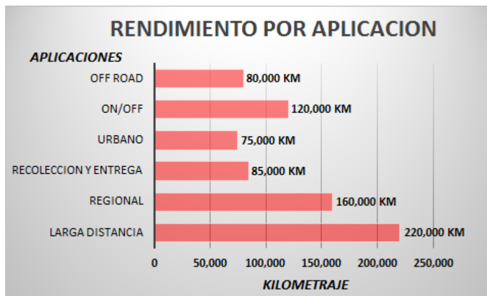
Figura 2.1 Grafica de Rendimientos aproximados por aplicación de llanta. “(Bridgestone 2012).”
