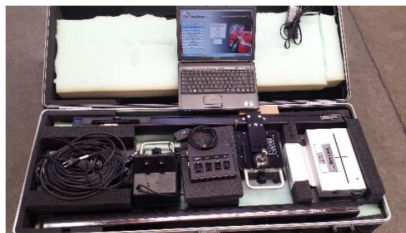
Figura 5.21 Imagen Equipo de Alineación Portátil.
