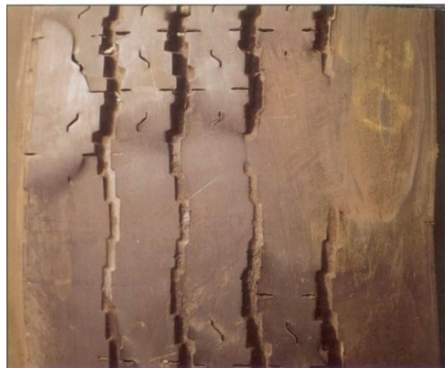
Figura 5.41 Imagen Desgaste Diagonal.
