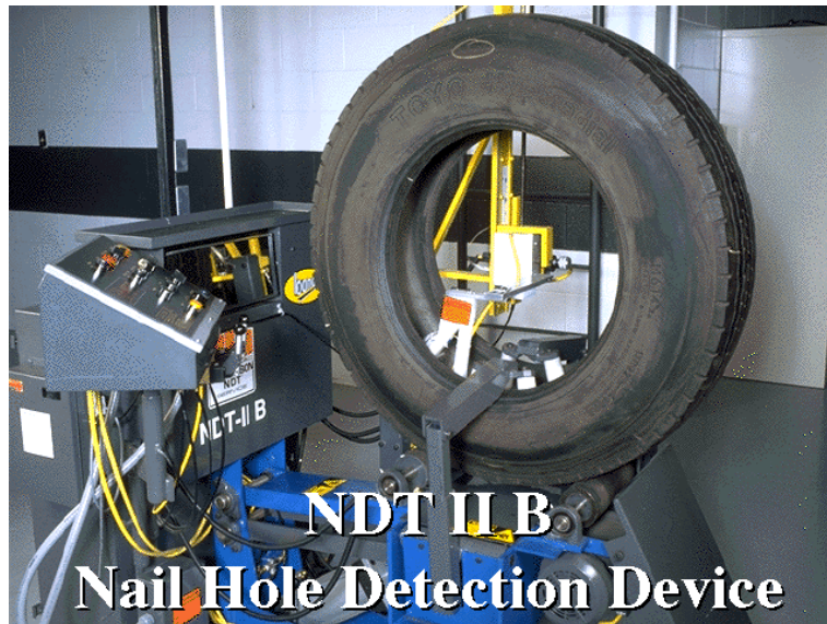
Figura 2.8 Maquina NDT II B para inspección inicial.
