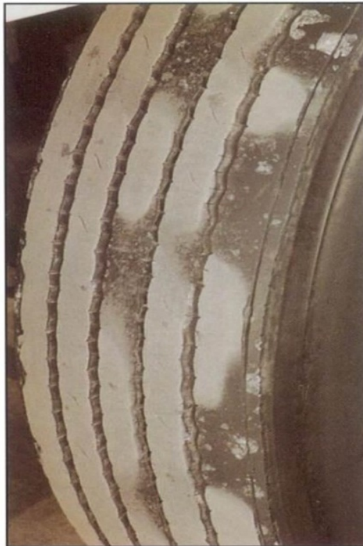
Figura 5.42 Imagen Desgaste Depresiones Intermitentes.
