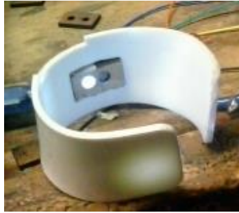
Imagen 73. Adaptación del sensor al brazalete.
