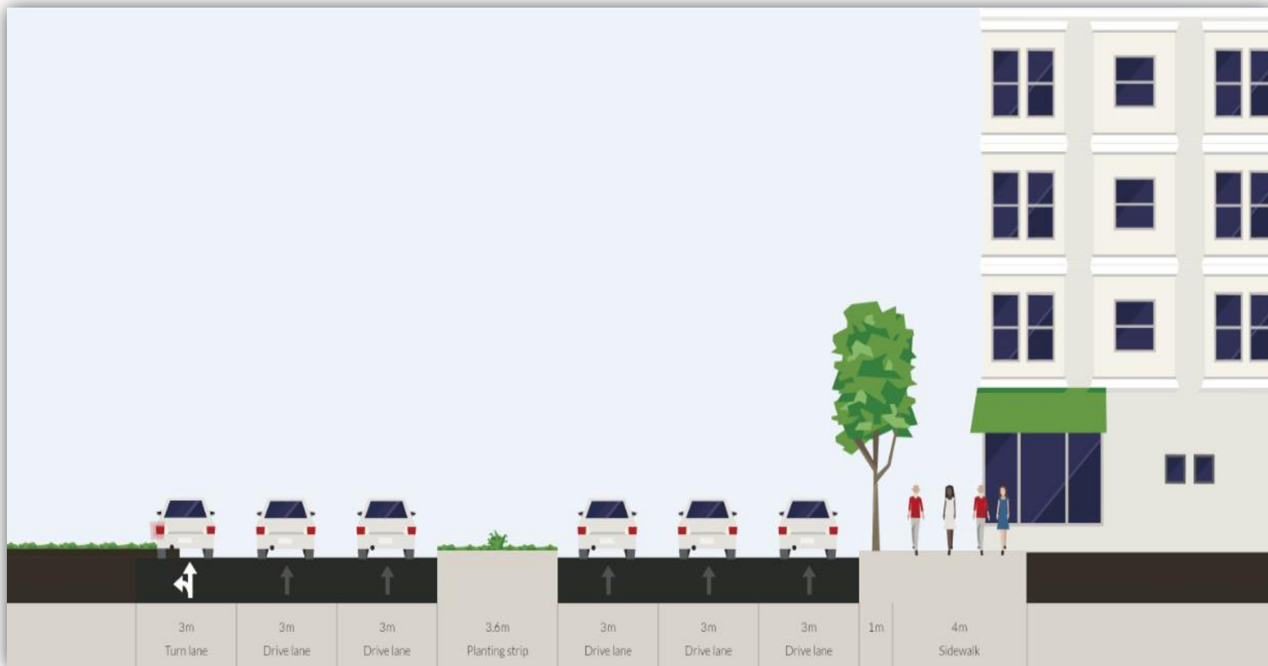
Ilustración 31 Sección transversal del cuerpo Norte de la Calz. Gral. Ignacio Zaragoza en el sentido de Oriente –Poniente en su cruce con Viaducto Río de la Piedad. Fuente: Elaboración propia mediante el programa streetmix.
