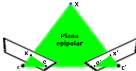
Figura 2.6: Visualización de la geometría epipolar, se genera un plano entre los centros de cámara y el punto de referencia.
