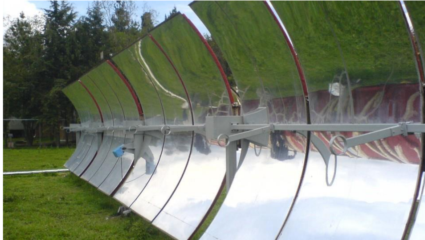
Figura 11. Fotografía de una línea de CCPs en la planta solar del IIUNAM. Jessica Fernández (2017)
