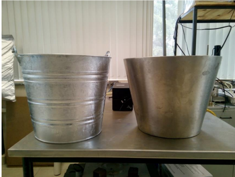
Figura 19. Fotografía de la olla comercial (cubeta galvanizada) y olla fabricada (doble pared). Jessica Fernández (2017).
