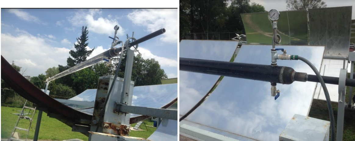
Figuras 26 y 27. Fotografías del tubo absorbedor ya colocado en el concentrador y vista a detalle del manómetro y las boquillas y válvula para permitir la salida del vapor respectivamente. Bernd Weber (2017).
