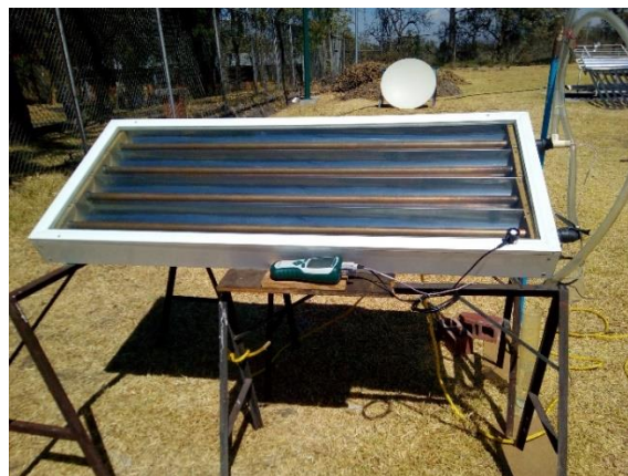
Figura 20. Fotografía del captador-concentrador con tubos de cobre (como absorbedores) sin pintar. Jessica Fernández (2017).
