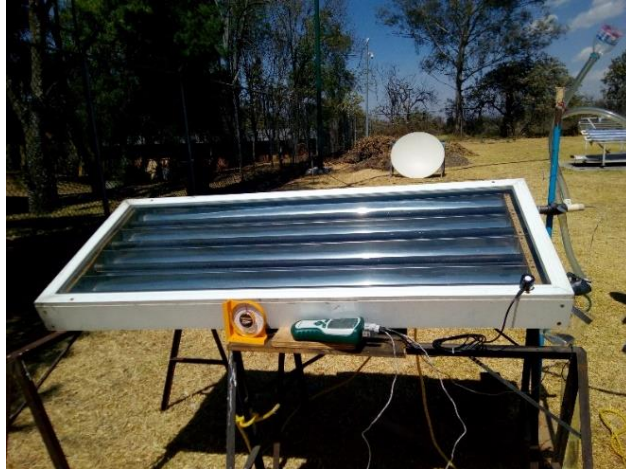
Figura 21.. Fotografía del captador-concentrador con tubos absorbedores pintados de color negro. Jessica Fernández (2017).
