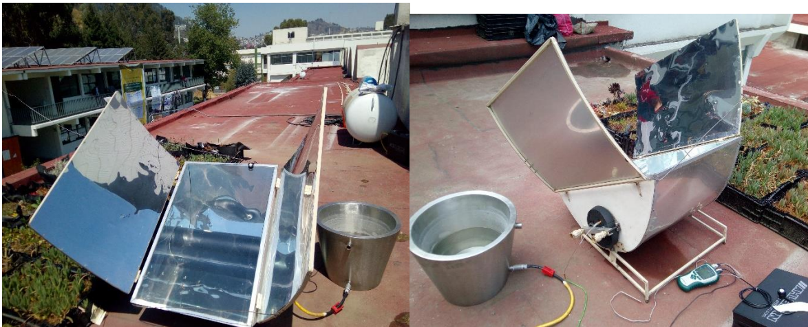
Figuras 22 y 23. Fotografías de la vista frontal y posterior respectivamente, de la cocina solar de Eduardo Rincón conectada a la olla. Jessica Fernández (2017).
