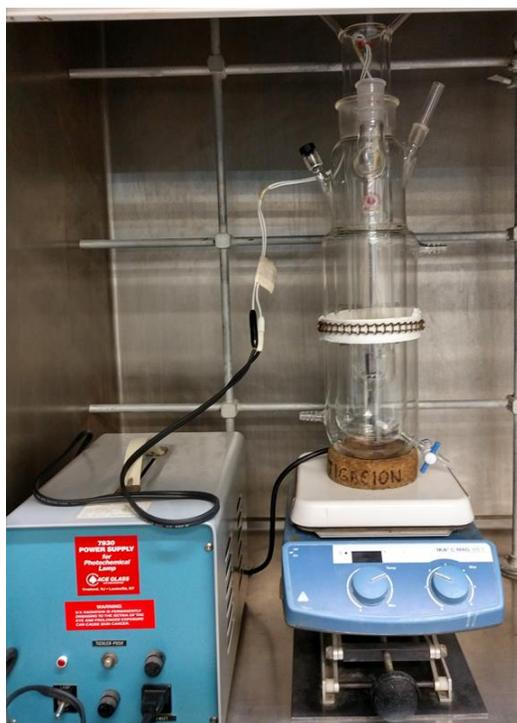
Figura 7: Lámpara de inmersión de luz UV-Vis con foto reactor
