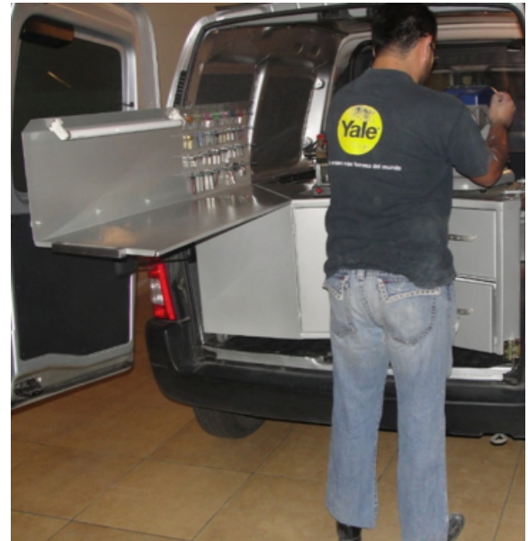
Fotografía 49: Uso de la Estación de Trabajo para elaborar llaves de alta seguridad Fuente: Fotografía del autor
