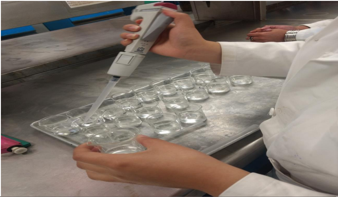
Figura 33. Solución Merlich en muestras de agua.
