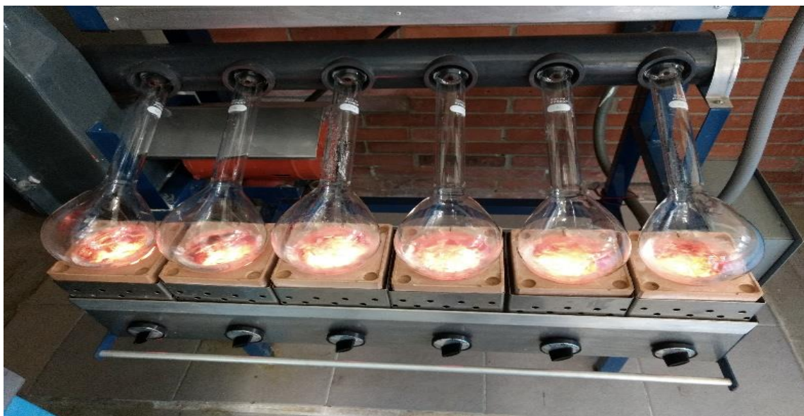
Figura 36. Digestión de las muestras
