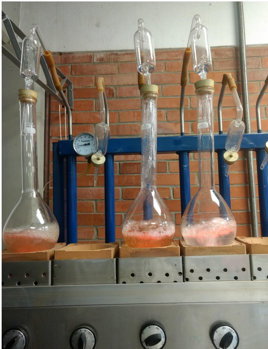
Figura 37. Destilación de muestras.
