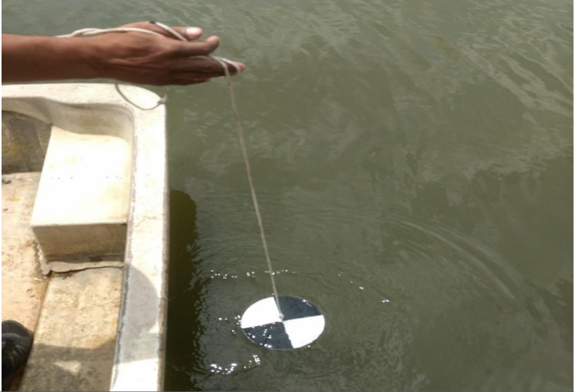
Figura 31. Introducción del Disco Secchi en la columna de agua.
