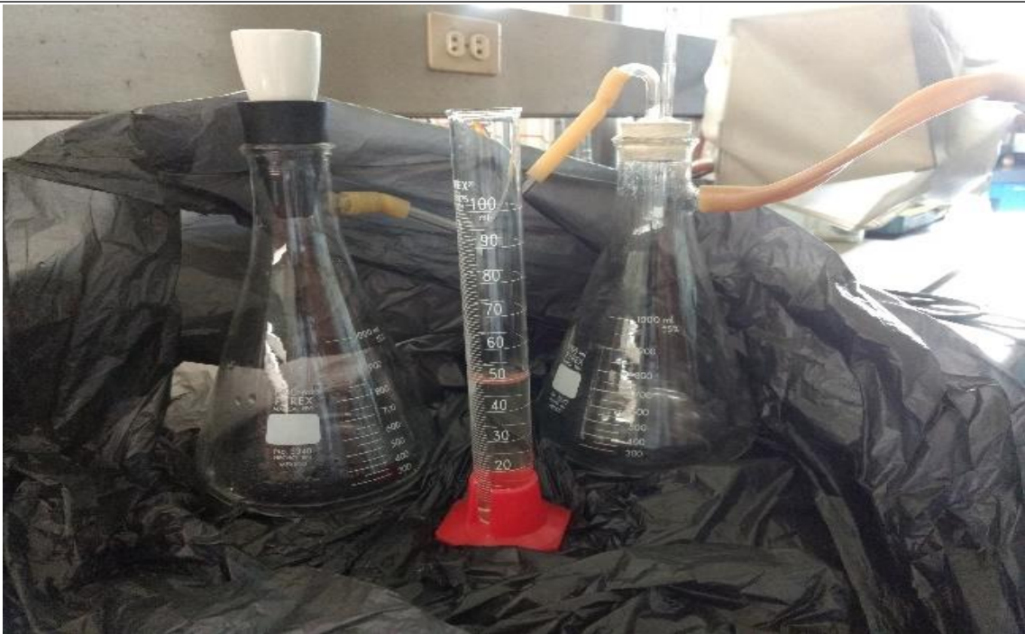
Figura 39. Filtración y obtención del material particulado de la muestra.
