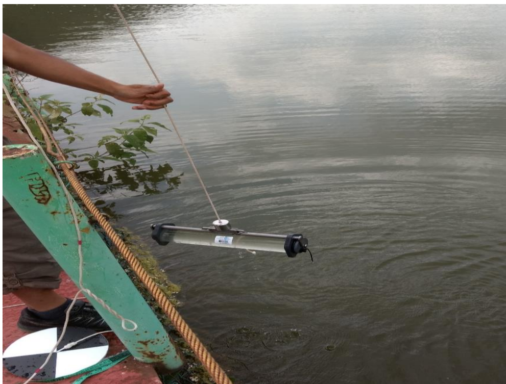
Figura 29. Toma de muestra a profundidad con la Botella Van Dorn.
