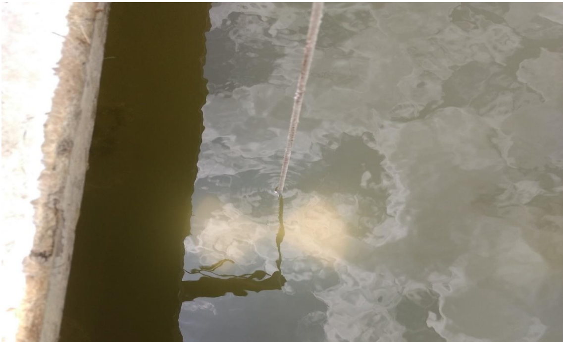
Figura 32. Disco Secchi en la columna de agua.
