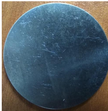
Figura 40:Acero HS-LA con superficie plana
