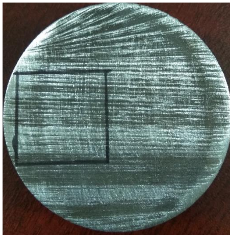
Figura 34: Área y pieza de acero tratado sin pulido
