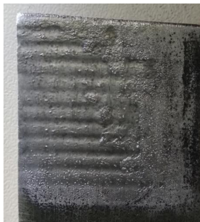
Figura 39: Pulido con gran desprendimiento en acero 10-12
