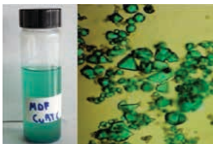
Figura 10. Izquierda: suspensión obtenida de HKUST-1; derecha: cristales de HKUST-1 con forma de poliedros vistos a 40x.
