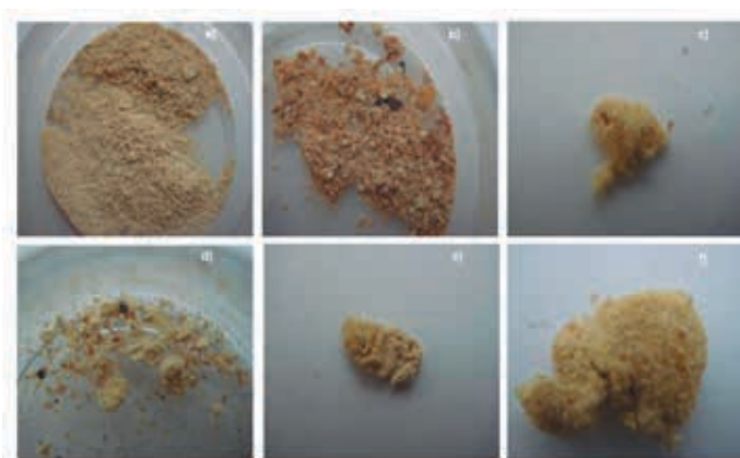
Figura 7. Polímeros particulados de furano a las energías de síntesis estudiadas: a) 20 W, b) 40 W, c) 60 W, d) 80 W, e) 100 W y f) 120 W.
