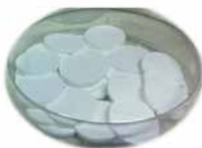
Figura 6. Discos de \alpha -Al 2 O 3 obtenidos para su uso como soportes.
