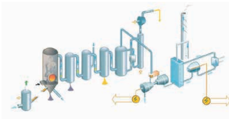
Figura 3. Tecnología de captura en pre-combustión (Morales et al. , 2008).
