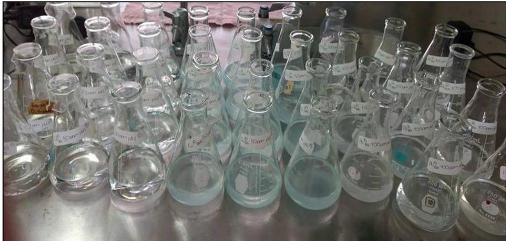
Figura 4.6 Precipitados de plomo y cobre a pH 7
