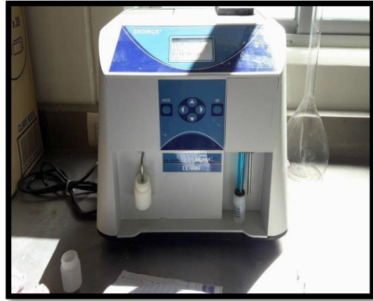
Fig 14, 15, 16: Ekomilk Bond Started, se utilizó para la determinación de perfil fisicoquímico de las muestras de los 16 proveedores, detectando grasa, solido, lactosa y proteína.
