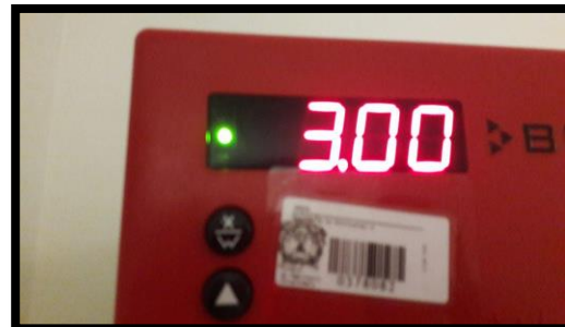
Fig 12 y 13: Incubadora Binder programada a 64 grados centígrados durante 3 horas para la incubación del Delvotest SP NT.
