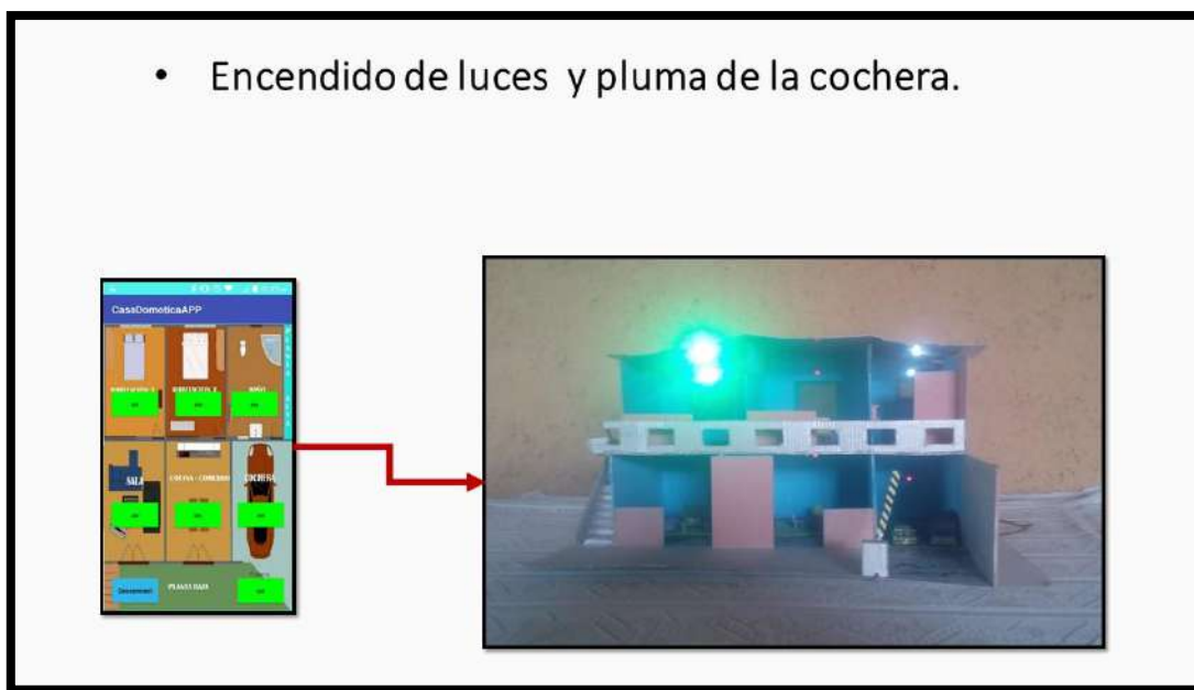
Figura 66. Prueba del sistema domótico, encendido de luces y pluma de acceso de la cochera.
