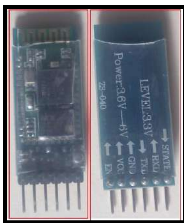
Figura 13. Módulo Bluetooth HC-05.
