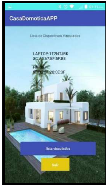
Figura 38. Selección del botón "lista vinculados" y despliegue de lista de dispositivos vinculados al Smartphone.
