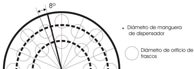
Figura 3.10. Determinación de tolerancia máxima de error acumulado en la posición del dispensador
