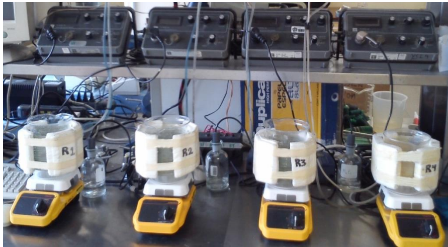
Figura 8. Reactores utilizados en las corridas de degradación y respirometría.
