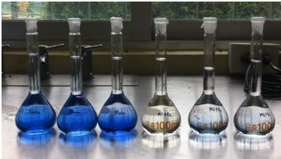
Figura 8. Reactivo índigo II; se consideró como blanco (lado izquierdo) y reactivo índigo II con la muestra uno de agua ozonada (lado derecho), por triplicado cada uno.
