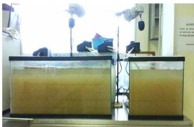
Figura 4. Producción del lodo modelo I-XH. Reactor A (lado derecho) y reactor B (lado izquierdo).
