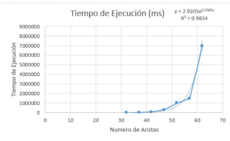
**Figura 4-6.** Incremento en Tiempo de Ejecución en gráficas de 28 vértices.
