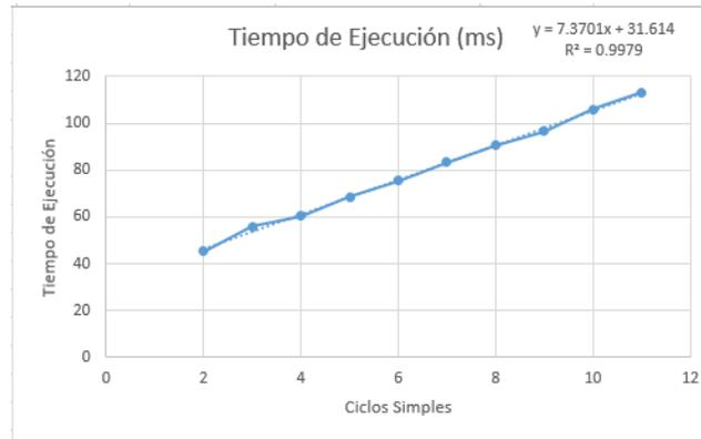
**Figura 4-1.** Incremento en tiempo de ejecución del algoritmo para gráficas cactus manteniendo constante el número de vértices en cada ciclo simple.
