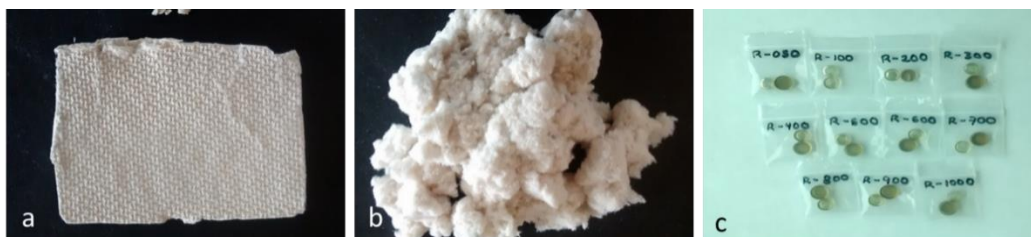
Figura 2.1. Fibras de celulosa de envases Tetra Pak a) papel kraft, b) molida y c) resina reticulada para su modificación.
