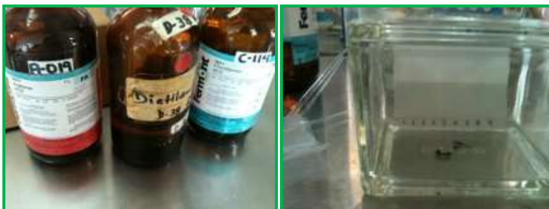
FIGURAS 100 Y 101. Imágenes que representan los compuestos utilizados para correr las cámaras para cromatografía, así como una placa de gel sílice que está siendo sometida a dicha prueba.
