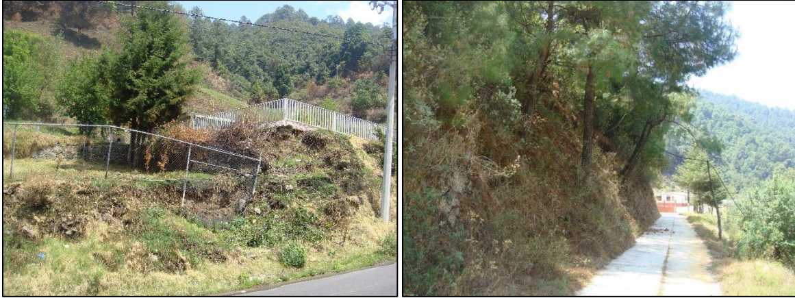
Figura 4. 12 Evidencias asociadas a los movimientos de reptación, localizados en las localidades de Dolores, donde se observa la inclinación de las cercas (izquierda); y en el barrio Cantingón, se observa la inclinación de los arboles (derecha). Fuente: Trabajo de campo (2016).
