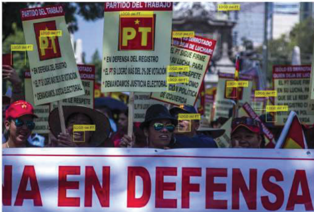
FIGURA 5.2: Falsos positivos detectados por el algoritmo Viola-Jones con solo 50 imágenes de entrenamiento
