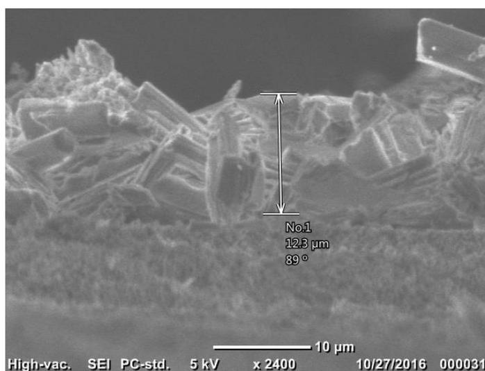
Fig. 42. Imágenes SEM de la superficie morfológica de la membrana de BioMOF. Parte superior (Imagen superior) y sección transversal (Imagen inferior).
