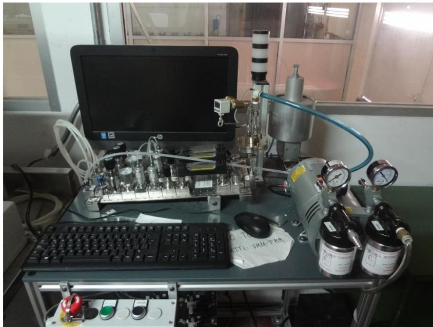
Fig. 34. Equipo de Permeación de Gases CCIQS
