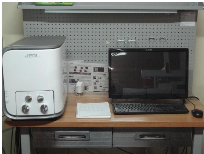
Fig. 30. Microscopio Electrónico de Barrido JEOL JCM-6000
