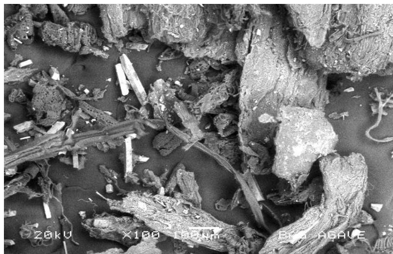
**Figura 3.6.** Micrografía electrónica de barrido de vacío controlado de la biomasa de bagazo de agave observada a 100 X después del proceso de molienda y tamizado.
