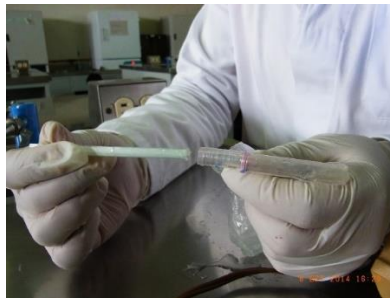
Imagen 40. Se introduce en el catéter un cartucho de fibra óptica rasgada para transmitir la luz ultravioleta germicida después de que este se sumergió en una suspensión bacteriana. (Imagen obtenida de mi archivo personal)
