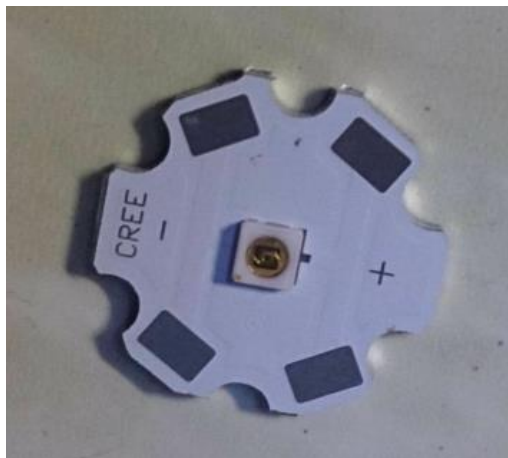
Imagen 12. LED UVC junto con su placa de montaje del LED. (Imagen obtenida de mi archivo personal)
