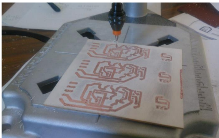
Imagen 22. Se realizan las perforaciones en los lugares donde se ubicaran los componentes con la ayuda de una Herramienta rotativa de la marca Dremel. (Imagen obtenida de mi archivo personal)
