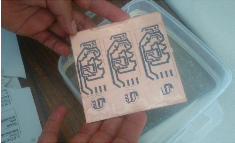
Imagen 19. Se decide imprimir tres circuitos en la placa de cobre para aumentar la probabilidad de tener circuitos con las pistas completas y en caso de que presenten discontinuidad en las pistas se procede a completarlas con marcador permanente. (Imagen obtenida de mi archivo personal)
