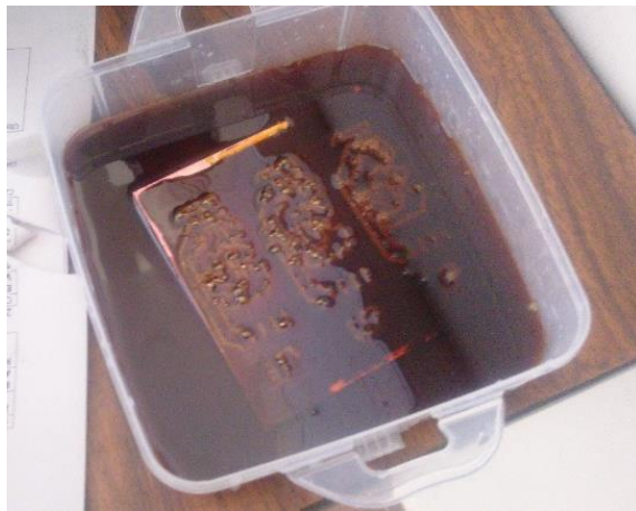
Imagen 20. Se sumerge completamente la tabla de cobre durante un tiempo aproximado de 15 minutos para eliminar el cobre que no se encuentra protegido por las pistas. (Imagen obtenida de mi archivo personal)
