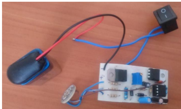
Imagen 24. Se soldán los componentes electrónicos a la tarjeta de acuerdo a la simulación hecha en la computadora y se coloca un interruptor para controlar la alimentación proveniente de la batería de 9 V. (Imagen obtenida de mi archivo personal)
