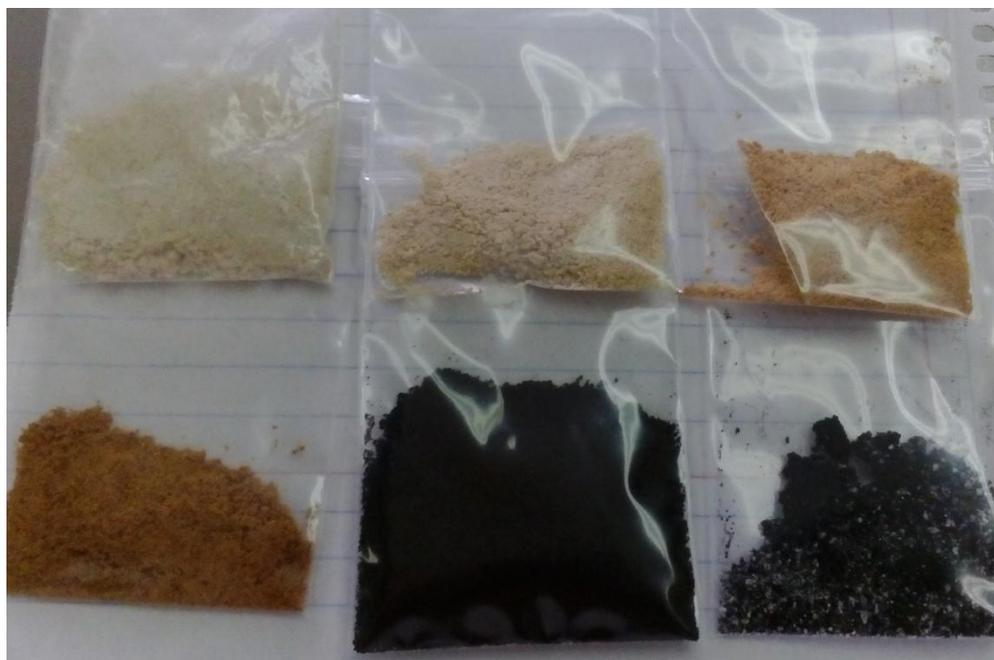
Figura 21 Fotografía de las muestras a diferentes tiempos en el horno, empezando en la izquierda superior avanzando hacia la derecha, muestra 100, 150, 180, 200,250 Y 300°C respectivamente.
