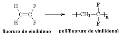
Figura 54. Polimerización por radicales libres del monómero fluoruro de vinilideno para la obtención de PVDF
