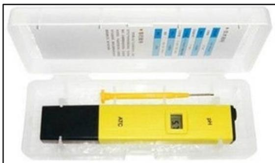
**Figura 30. Medidor de pH digital que se utilizó durante el experimento**
