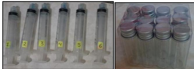
**Figura 28. Frascos de vidrio (20 mL) y jeringas desechables que se utilizaron para tomar las muestras de agua**
