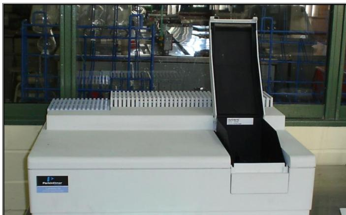
**Figura 31. Espectrofotómetro de UV**
