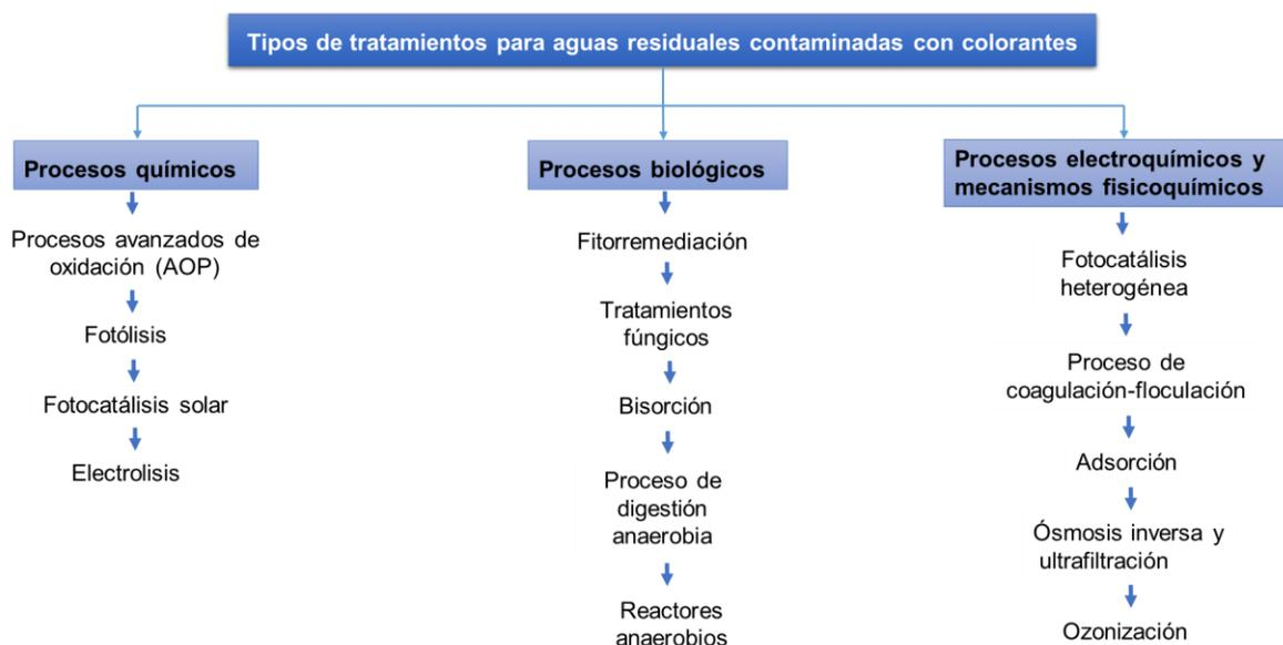
**Figura 17. Tipos de tratamientos para aguas residuales contaminadas con colorantes**
