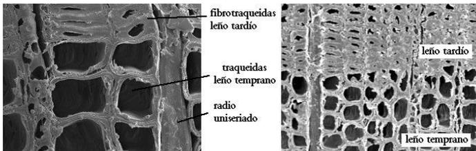
Imagen 11. En esta ampliación de microscopio, se puede apreciar a detalle el cuerpo cavernoso de la madera que al cercarse del agua que contiene, vuelve a este material un buen aislante térmico.
