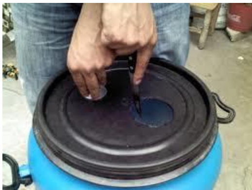
Figura 22. Perforaciones en la tapa del contenedor (Londres, 2016)
