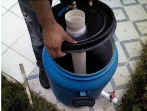
Figura 27. Sellado del contenedor (Londres, 2016)
