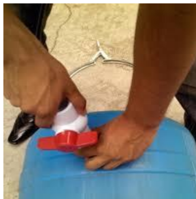
Figura 26. Perforaciones para salida del efluente (Londres, 2016)
