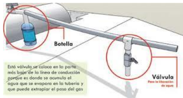
Figura 21. Tubería y válvulas (Machorro, et al. ; 2011)
