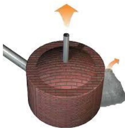
Figura 18. Cámara de digestión (Civilgeeks, 2015).
