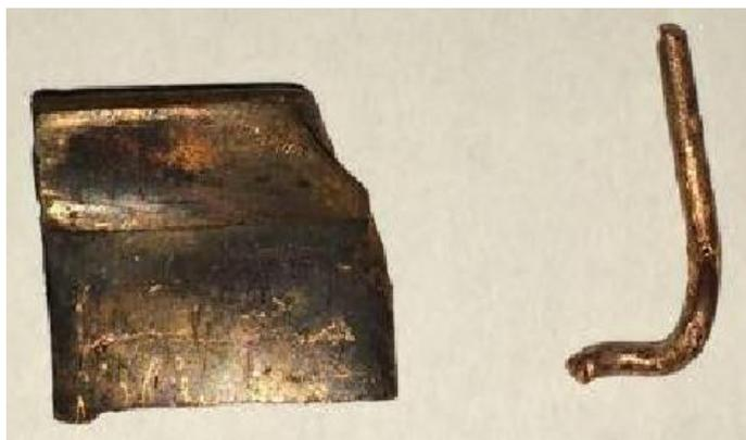
Figura 3.2.- Piezas de Cobre empleadas en la síntesis de las NP's de Cobre
