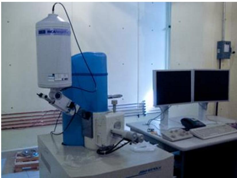
*Figura 3.7.- Microscopio Electrónico de Barrido JEOL JSM-6510LV, en el Centro Conjunto de Investigación en Química Sustentable. Fuente: Centro Conjunto de Investigación en Química Sustentable UAEM UNAM*
