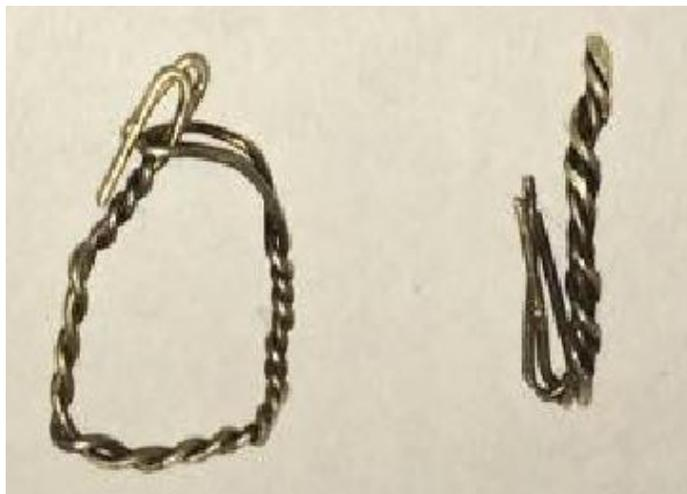
Figura 3.1.- Piezas de plata utilizadas la síntesis de las NP's de Plata
