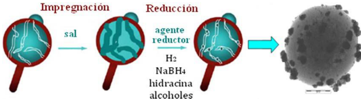
Figura 2. Representación esquemática de la preparación de nanopartículas soportadas por el método de deposición/reducción convencional [29].
