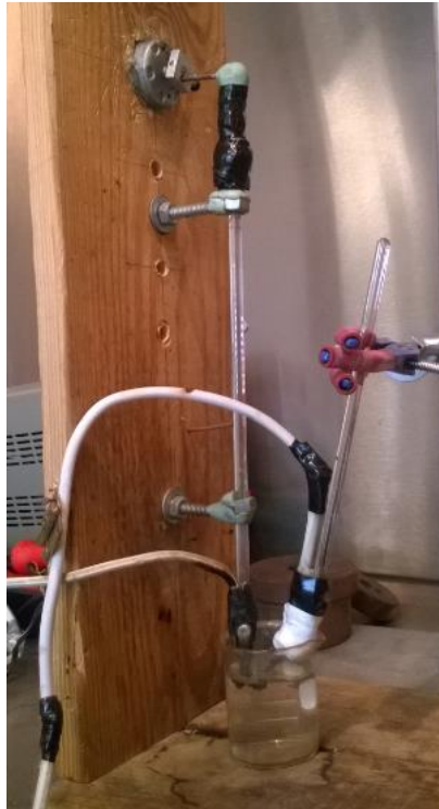
Figura 10 Dispositivo: Plasma Pulsado en Líquidos (PPL) utilizado para generar nanopartículas bimetálicas.
