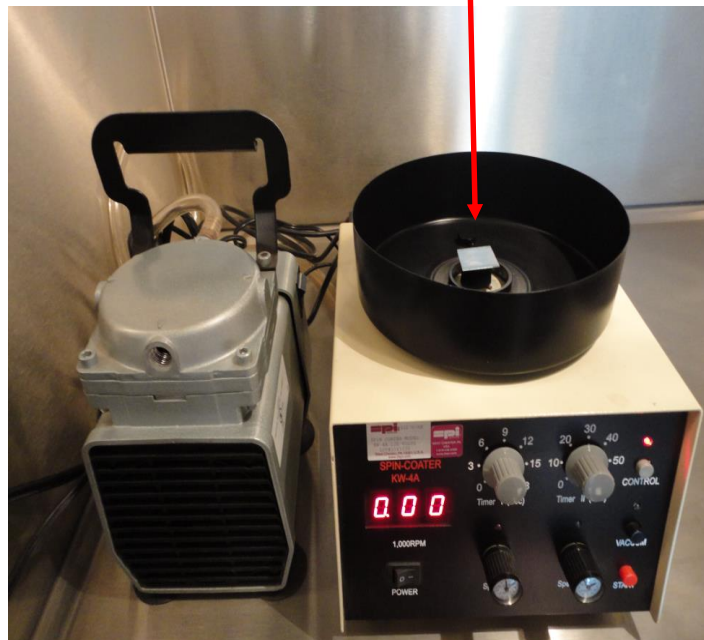
Figura 3.1 Equipo Spin-Coater KW-A4, ubicado en CCIQS UAEM-UNAM
