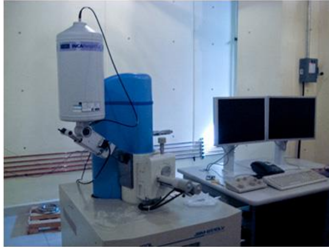
Figura 3.5 Microscopio Electrónico de Barrido JEOL JSM 6510 LV, ubicado en CCIQS UAEM-UNAM
