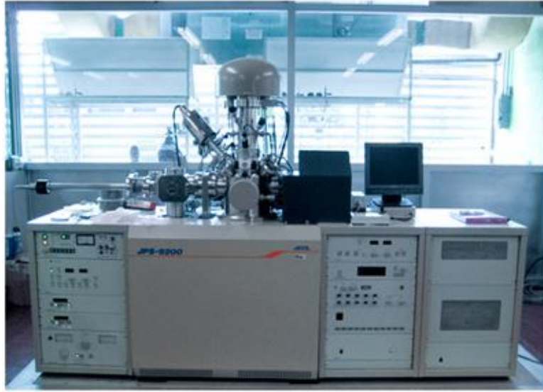
Figura 3.5 Equipo de Espectroscopía Fotoelectrónica de rayos X, JEOL JPS-9200, ubicado en CCIQS UAEM-UNAM
