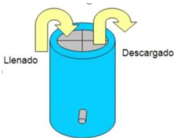
Figura 10 Biodigestor discontinuo. Fuente propia
