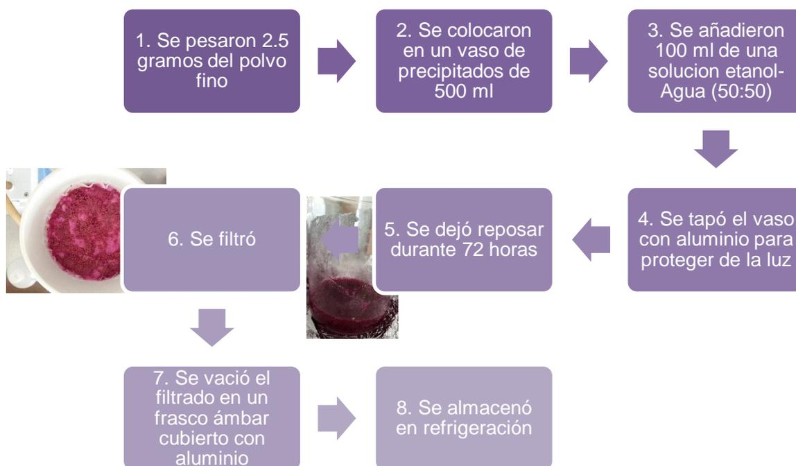
Figura 6 Procedimiento para la obtención del extracto con etanol-agua 50:50 (EB).
