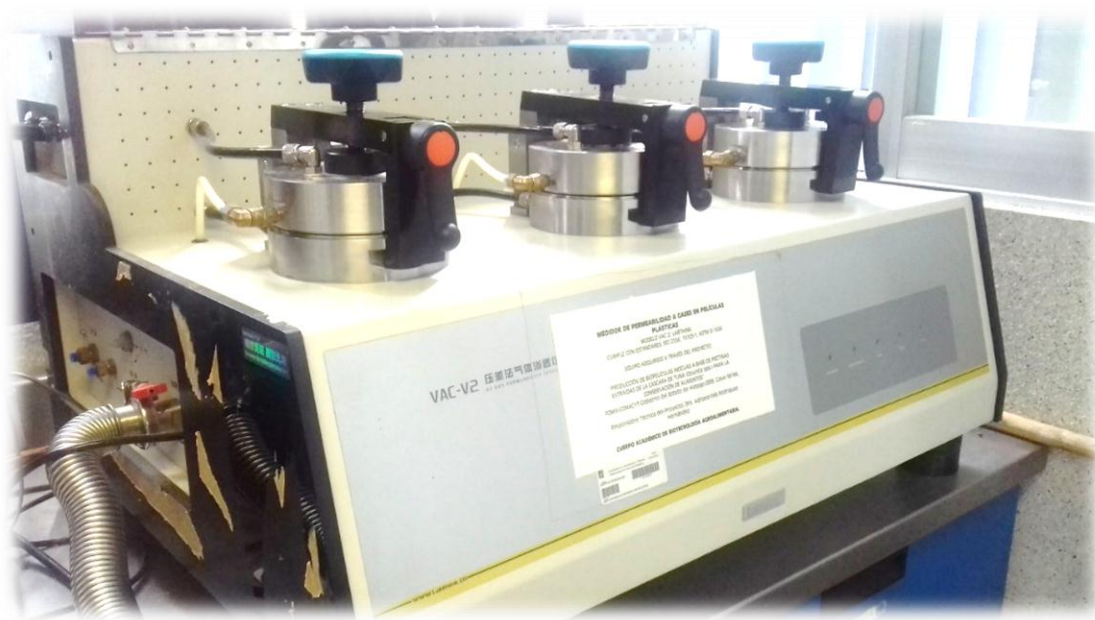
Figura 14 Equipo VAC-V2 (Labthink, China) para medir permeabilidad al oxígeno de las películas plásticas
