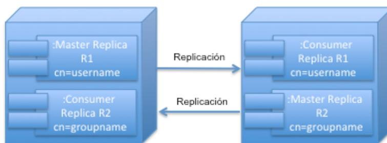
Figura 2.5 Esquema de replicación multimaestro
