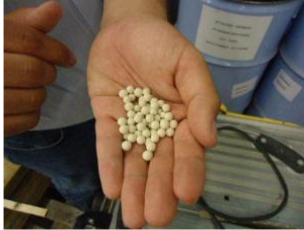
Figura 6.14 Medio filtrante, Fuente vistó en la Fabrica de filtros 3pTechnik en Donzdorf Alemania (Elaboración Propia).
