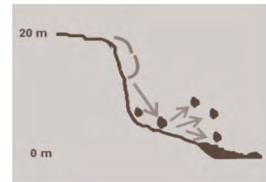
Figura 1. Desprendimientos y caídas
