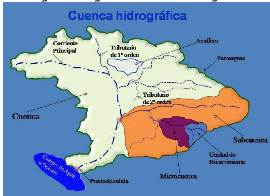
Figura 2.2. Diagrama de una Cuenca Hidrográfica.
