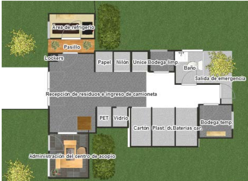
Imagen 4. Instalaciones del centro de acopio de residuos sólidos
