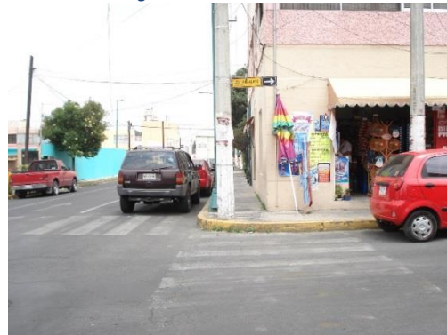
Figura 13. Mobiliario sobre banqueta y falta de rampas. Fuente: Ana Laura González Rodríguez.
