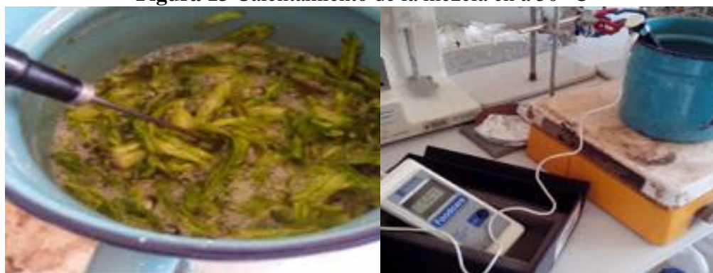
Figura 13 Calentamiento de la mezcla en a 50 °C
