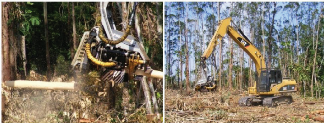
Figura 1. Cosechadora forestal, cabezal Kesla adaptado a la excavadora Caterpillar, Huimanguillo, Tabasco
