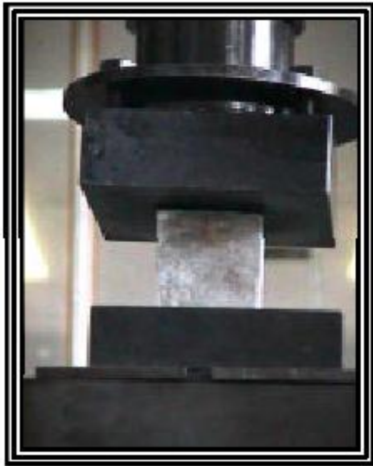
Prueba de resistencia del mortero en compresión
