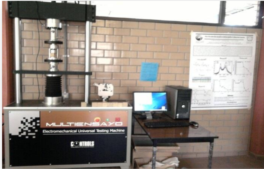
Figura 3.4 Máquina Multiensayo Controls MR localizada en el LIDMA de la Facultad de Química.
