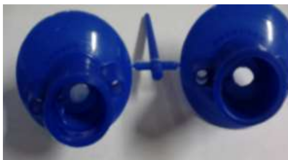
Figura 39. Desgarre en cuerda interna
