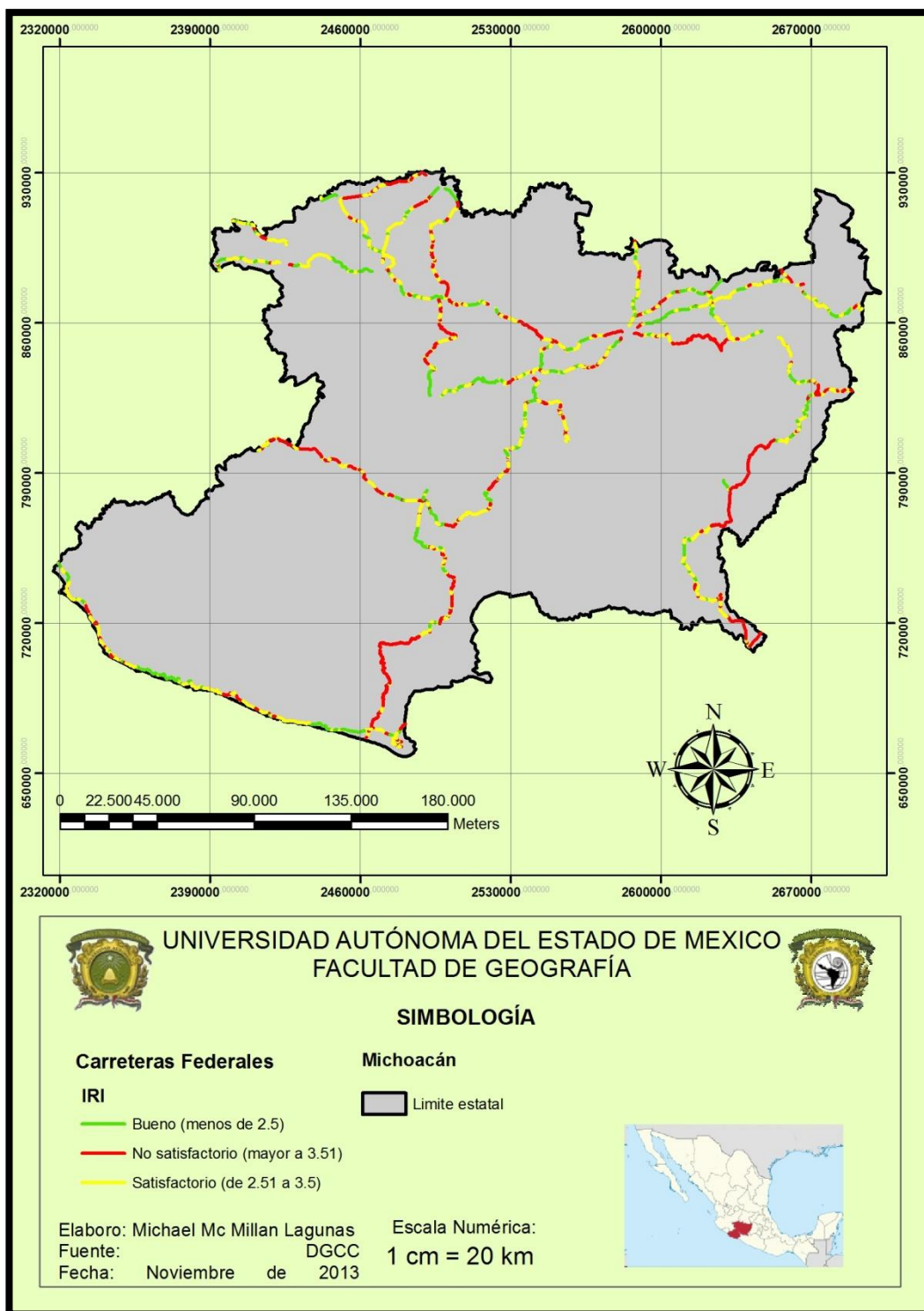
MAPA 13: IRI de las carreteras Federales de Michoacán. Este indicador muestra la respuesta de un vehículo a las condiciones de un camino, midiendo verticalmente las deformaciones y de esta manera se puede notar claramente los tramos en donde existe mayor desgaste.
