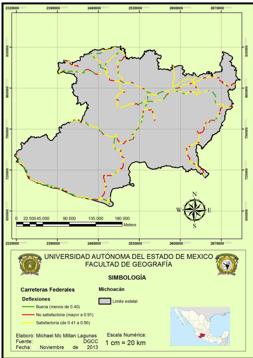
Mapa 12: Deflexiones del Estado de Michoacán (2009). El desgaste del pavimento es clasificado de acuerdo a tres rangos considerados por la Dirección de Conservación de Carreteras, cabe destacar que la mayoría de los tramos carreteros se encuentra en malas y regulares condiciones, lo cual determina que en los tramos rojos se debe de hacer trabajos de conservación, mantenimiento o de ser su caso construcción.
