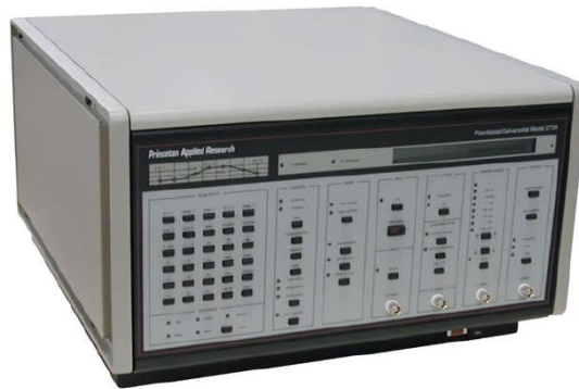
Figura 12. Potencióstato-galvanostato EG&G Princeton Applied Research Model 273A en donde se realiza la electrodeposición de películas de ZnO
