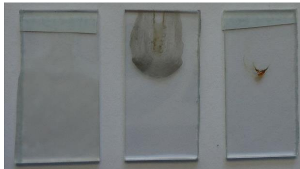
Figura 19. Depósito a 25, 30 y 40°C.
