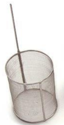
Figura 10. Contra electrodo, malla de platino
